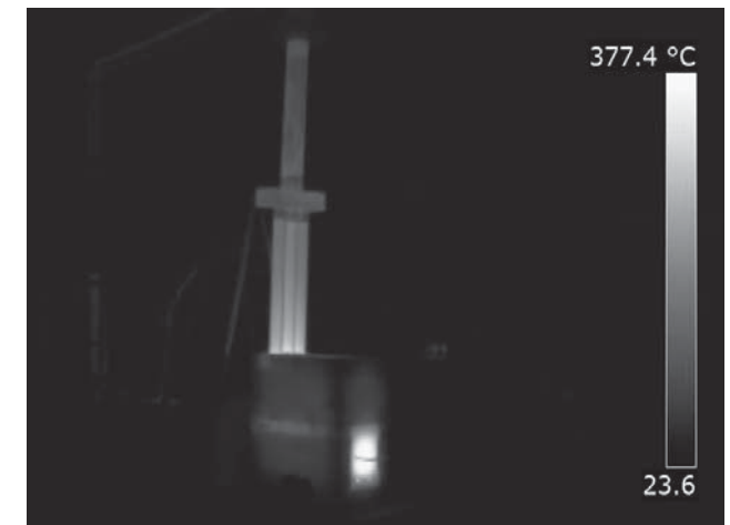
Termografía de la estufa durante los ensayos, realizada en simultáneo al ensayo de evolución del rendimiento y monóxido de carbono.
